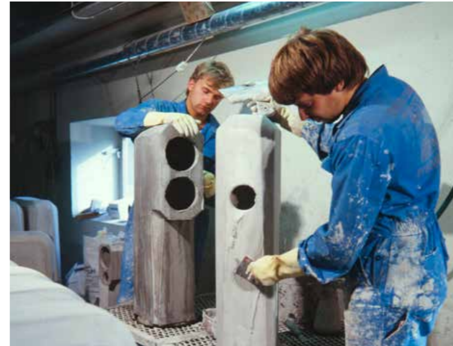
Några anställda spacklar Raunahögtalare i fabriken i Åtorp. Just spacklingen blev tidsödande när produktionen ökade. Det nya färgsystemet var tänkt att minska den arbetsbördan, men blev istället slutet för Rauna.
